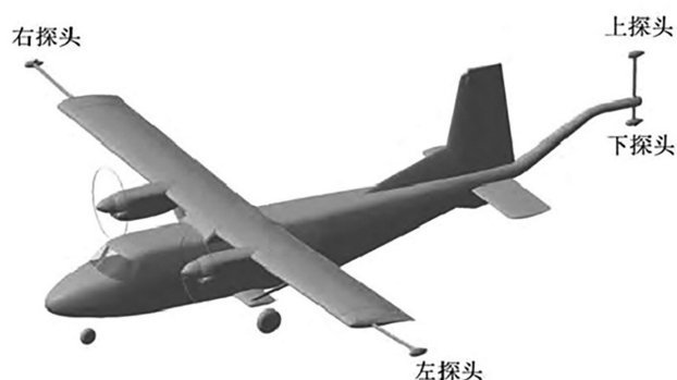
图1 梯度系统磁探头安装示意(90°方向)(引自 [10] )
